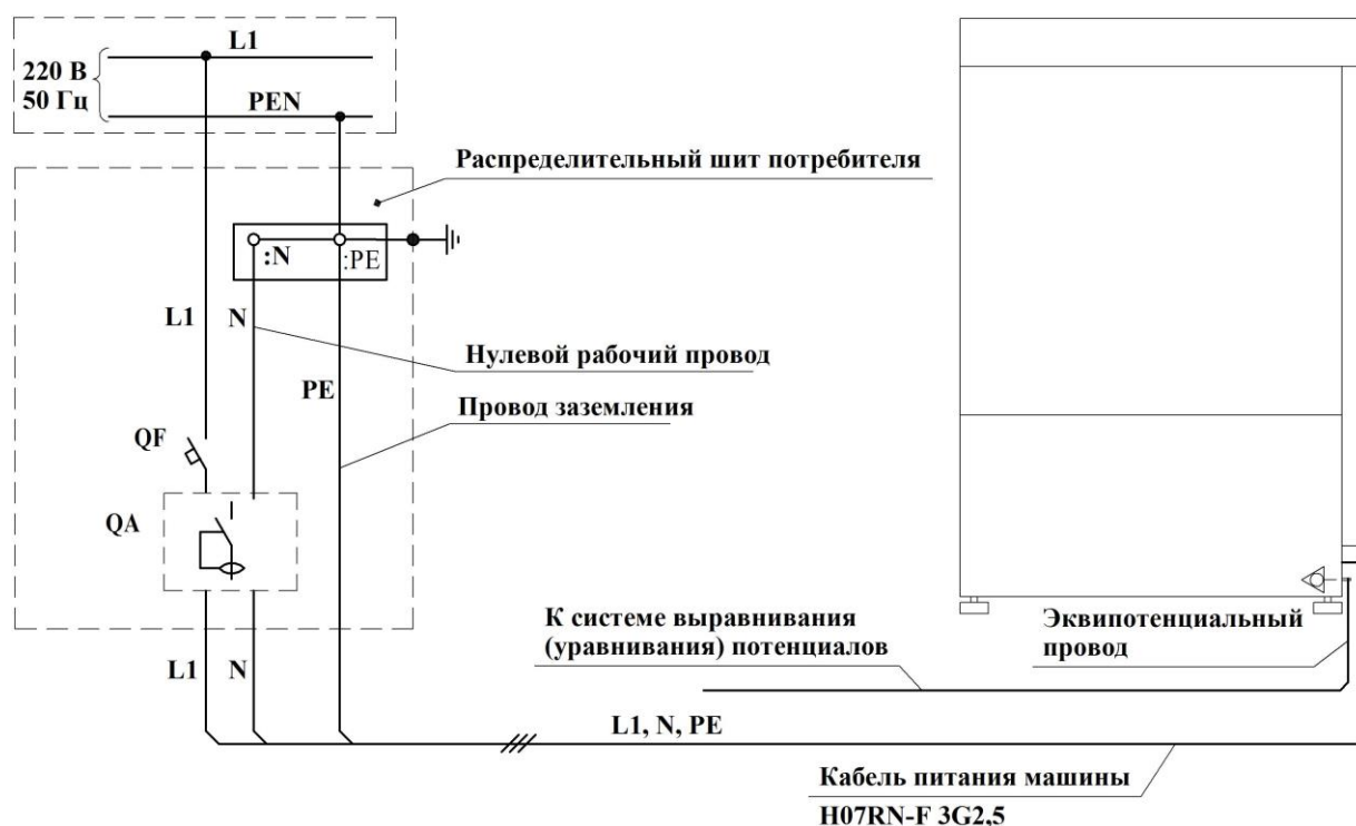
Рисунок 7 – Схема подключения к электрической сети
